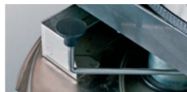
drążek nawrotnika przepływu powietrza do czyszczenia filtra
