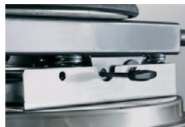
drążek nawrotnika przepływu powietrza do czyszczenia filtra
